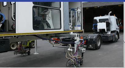
Le porteur est équipé d'une plaque SETRA avec ses prises hydrauliques et d'une source hydraulique destinée à la saleuse.
